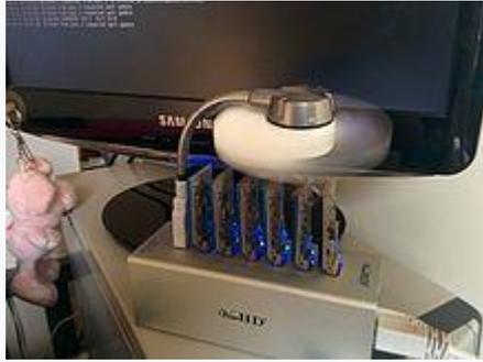
Блок из нескольких [ASIC](#)-плат в форме USB-модулей, широко используется для [майнинга](#) с 2013 года
